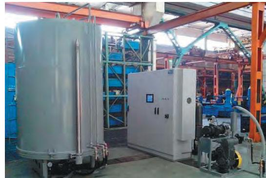
Оборудование обеспечивает сокращение продолжительности обработки в 2–5 раз, снижение расхода рабочих газов в 20–100 раз и удельных затрат электроэнергии в 2–3 раза по сравнению с традиционным газовым азотированием. Технический уровень и стоимость оборудования позволяют успешно конкурировать с известными зарубежными фирмами.
