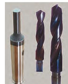
Метод включает азотирование поверхности и нанесение покрытий путем комбинированного физико-химического осаждения в одном технологическом цикле.
