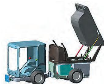
Комплексная компьютерная динамическая модель малогабаритной коммунальной машины
