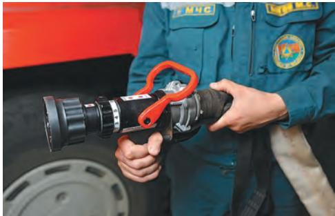
Новая модификация пожарного ствола СПРУК-50/0,7 широко применяется службами спасения Министерства по чрезвычайным ситуациям Республики Беларусь. Основной эффект – снижение расхода огнетушащего вещества до 5,7 л/с; снижение массогабаритных параметров (не более 1,8 кг); возможная установка пенной насадки.
