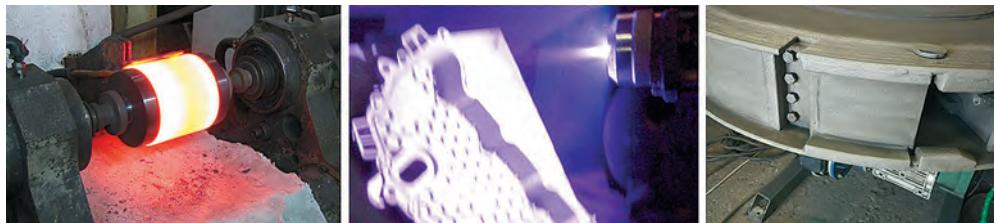
Процесс нанесения износостойкого покрытия на заготовку ролика прокатного стана методом индукционной наплавки
