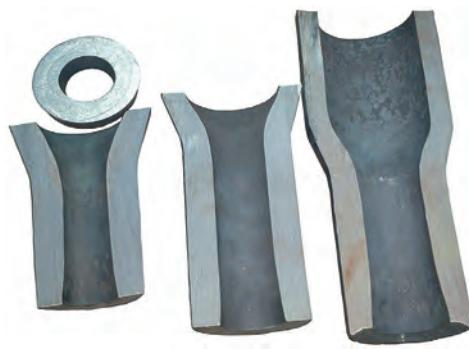
Освоено производство заготовок с использованием 3-валковой раскатки и индукционного нагрева, что обеспечивает повышение качества деталей, сокращение времени на последующие операции механической обработки, снижение затрат на энергоресурсы на 15–20 %, повышение производительности
